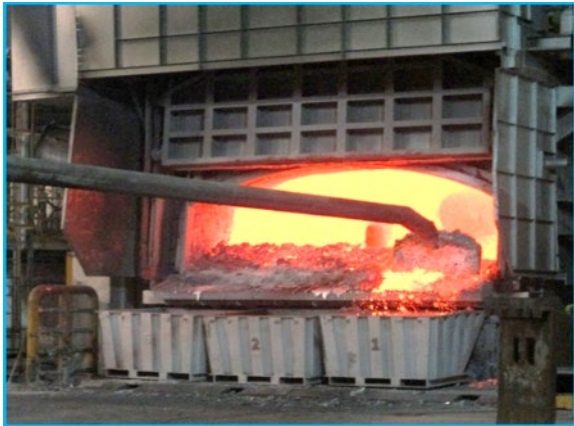
การโกยขยะกรันอลูมิเนียม DROSS จากเตาหลอม
